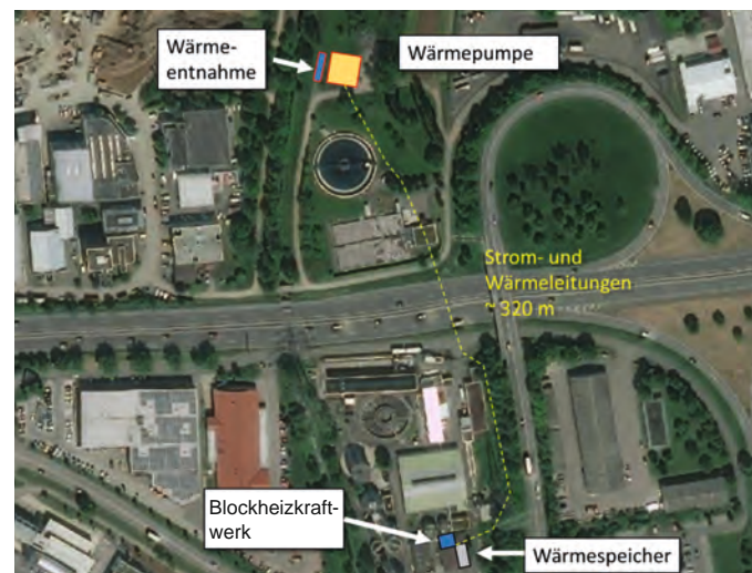
ABBILDUNG 2: LUFTBILD KLÄRANLAGE WEINSTADT MIT GEPLANTER ENERGIEUMWANDLUNG (BILDQUELLE: ESRI/ARCGIS)
