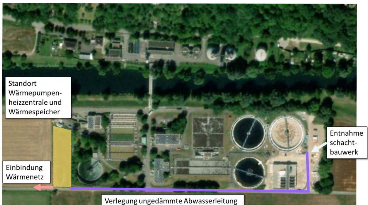
Abbildung 27: Luftbild Kläranlage Tübingen mit Darstellung des geplanten technischen Konzepts. Bildquelle: esri / ArcGIS.
