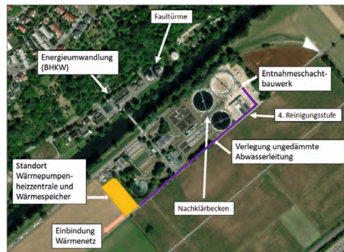
ABBILDUNG 2: GEPLANTE TECHNISCHE UMSETZUNG DER ABWASSERWÄRME NUTZUNG (BILDQUELLE: ESRI/ARCGIS)
