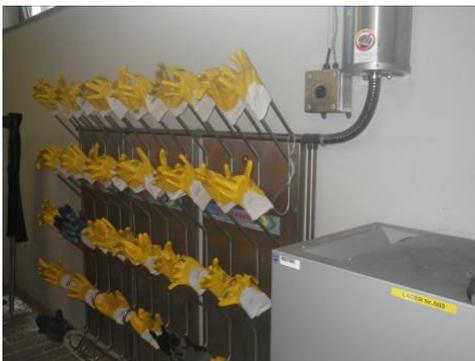
Beispiel: Trocknungsanlage für gereinigte Handschuhe (Quelle: BWB)
