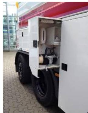
Beispiele Handwaschanlage an Kanalreinigungsfahrzeugen (Quelle: SEBD, BWB)
