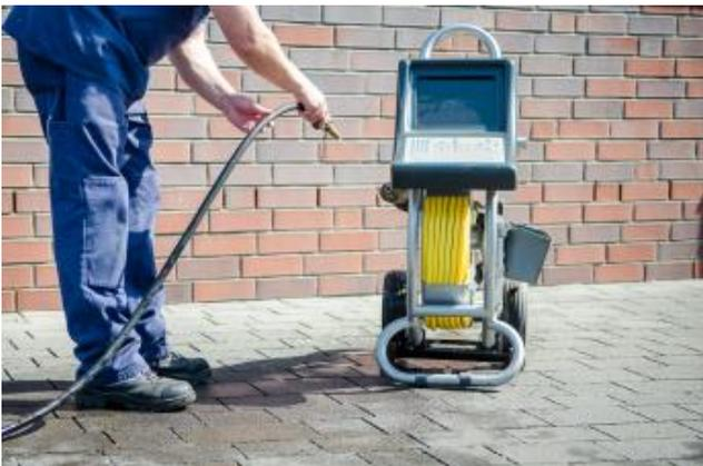
Reinigung Hausanschlusskamera (Quelle: BWB)
