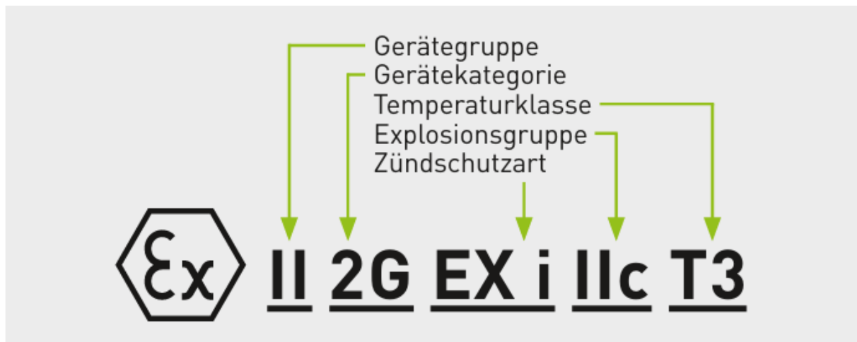
Abbildung 3: BEISPIEL FÜR EINE EXPLOSIONSSCHUTZKENNZEICHNUNG.
